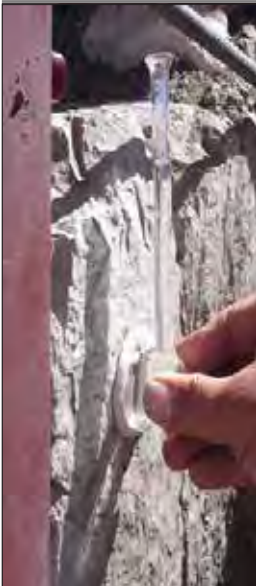
Prüfung Wasseraufnahmefähigkeit des Steins
