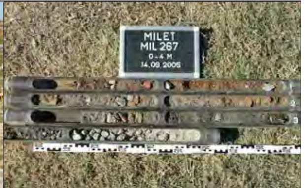
Bohrkern-Untersuchung der Sedimente (Uni Marburg)
