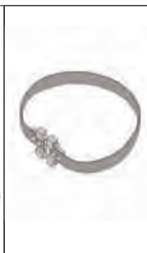
Sicherung der Säulen durch Edelstahlband
